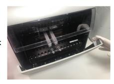
2. Maxwell RSCの動作が止まり、画面が切り替わります。Surfaceの画面において、『OPEN DOOR』のボタンを押します。
